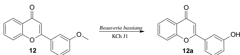
Schemat 8. Biotransformacje 3'-metoksyflawonu ( 12 ) w kulturze szczepu B. bassiana KCh J1
