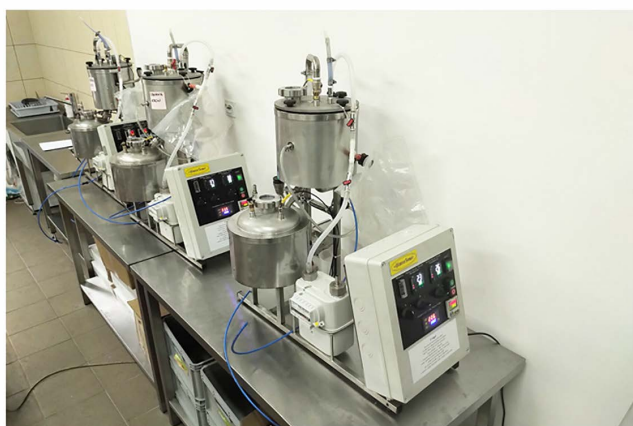
Rys. 1. Unikalny zestaw reaktorów do procesu fermentacji suchej opracowany w Instytucie Inżynierii Rolniczej Uniwersytetu Przyrodniczego we Wrocławiu
