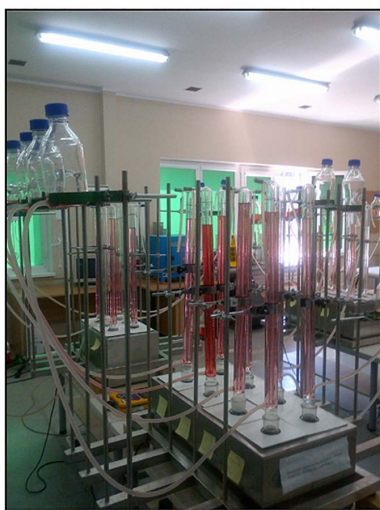
Rys. 3 Zestaw reaktorów do procesu fermentacji mokrej metodą stacjonarną (batch test)
